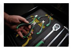
Alle Zangen besitzen ein durchgestecktes Präzisionsgelenk, Doppelblattfeder und Daumenablage für akkurates Arbeiten.
