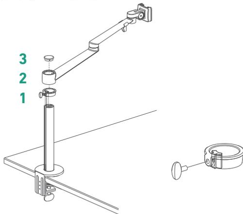
**DE Hinweis:** Bitte befestigen Sie die Innenmutter des Standfußes, bevor Sie die Schraube des Clips festziehen
