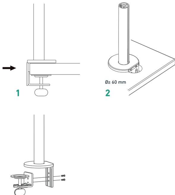
**DE** 1 Zur Montage an frei zugänglichen Arbeitsplatten. 2 Zur Montage durch ein Tüllenloch. **Achtung:** Vor dem Einsetzen des Standfußes entfernen Sie bitte Anschraubwinkel, indem Sie die Schrauben mit den mitgeliefertem Sechskantschlüssel lösen.
