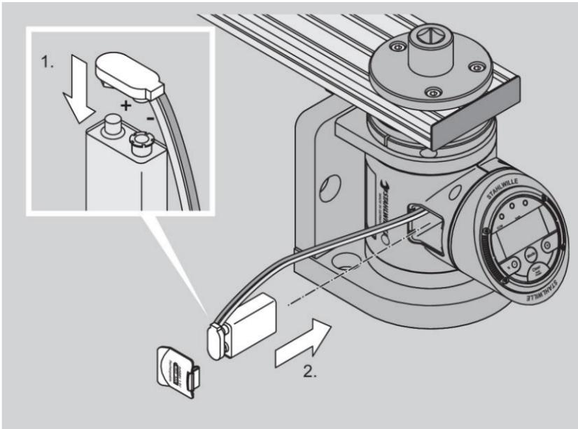
Pour utiliser l'adaptateur pour quatre piles/ batteries de 1,5 V AAA, procédez de la façon suivante :
