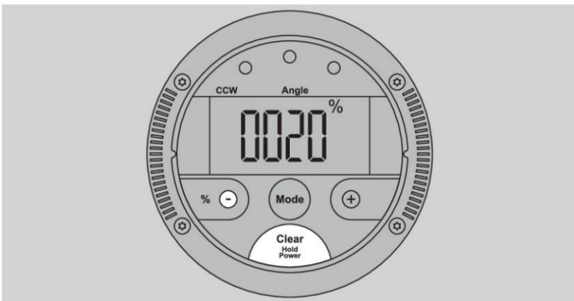
➤ Drücken Sie die Taste „–“ so oft kurz, bis der gewünschte Toleranzwert angezeigt wird.
